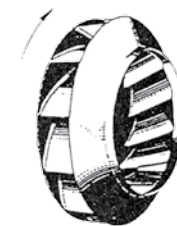
Figur 6.2. Radialventilator med bagud krummede skovle.
