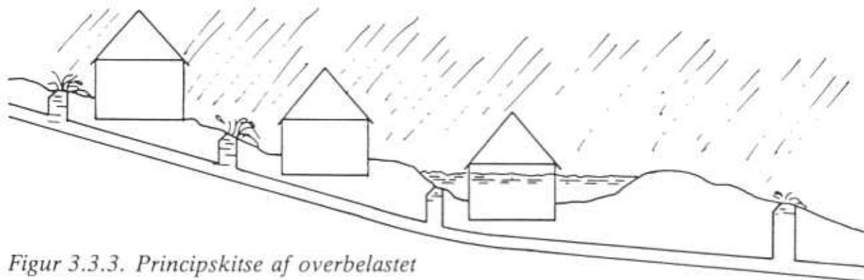
Figur 3.3.2. Principskitse af overbelastet fællessystem med kælderoversvømmelser.
